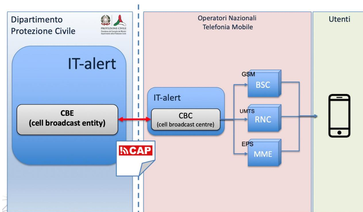
**Figura 1.** Servizio IT-Alert. Schema della catena di trasmissione.
