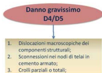
Figura 17. Caratteristiche danno gravissimo D4-D5.
