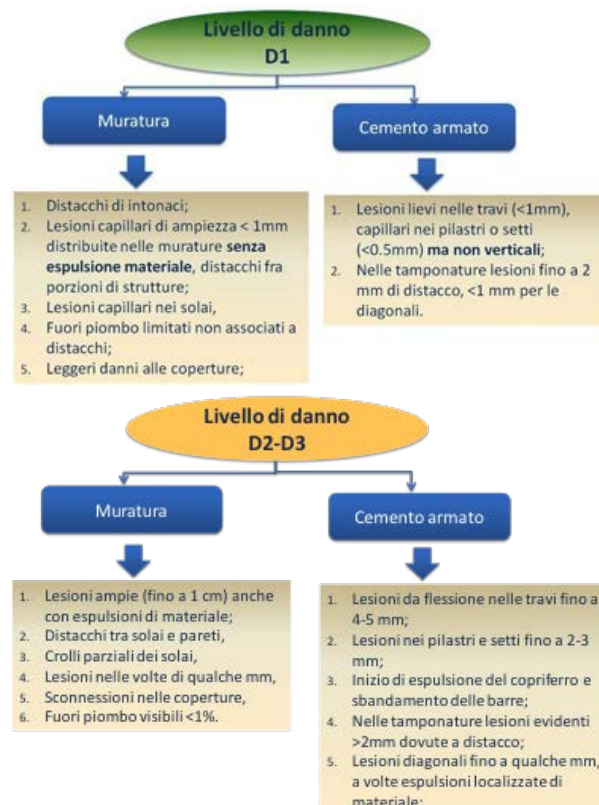
Figura 16. Caratteristiche quadri fessurativi associati ai danni D2-D3.
