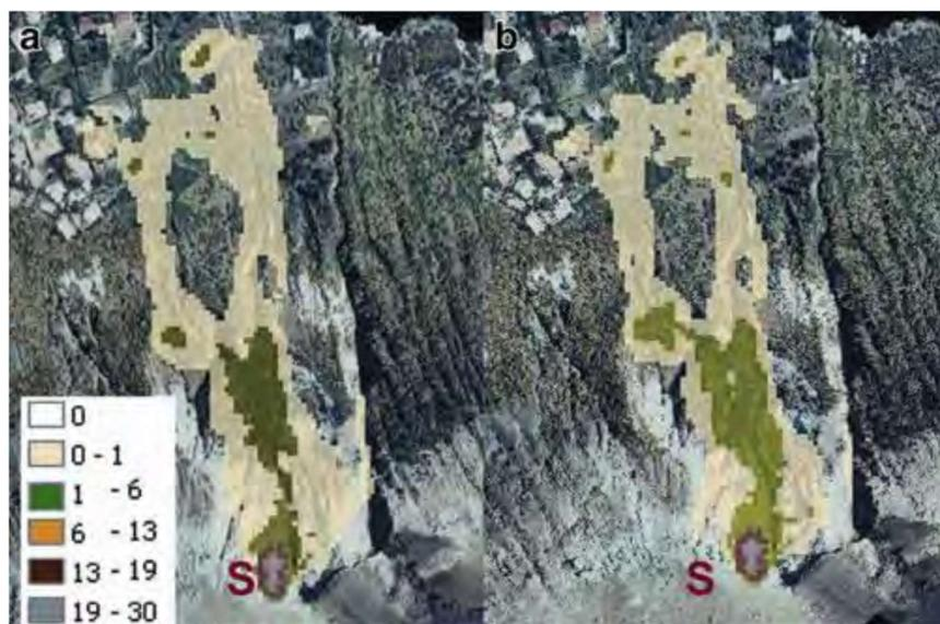
Figura 11: Area invasa dal detrito di frana usando un modello Voellmy: (a)  $m$  0.12 e  $x$  500  $m/s^2$  o (b)  $m$  0.15 e  $x$  1,000  $m/s^2$ . Legenda di colori a sinistra: spessore in metri del deposito di frana finale. L'area sorgente è marcata da una "S" rossa (da Marsella et al., 2013).
