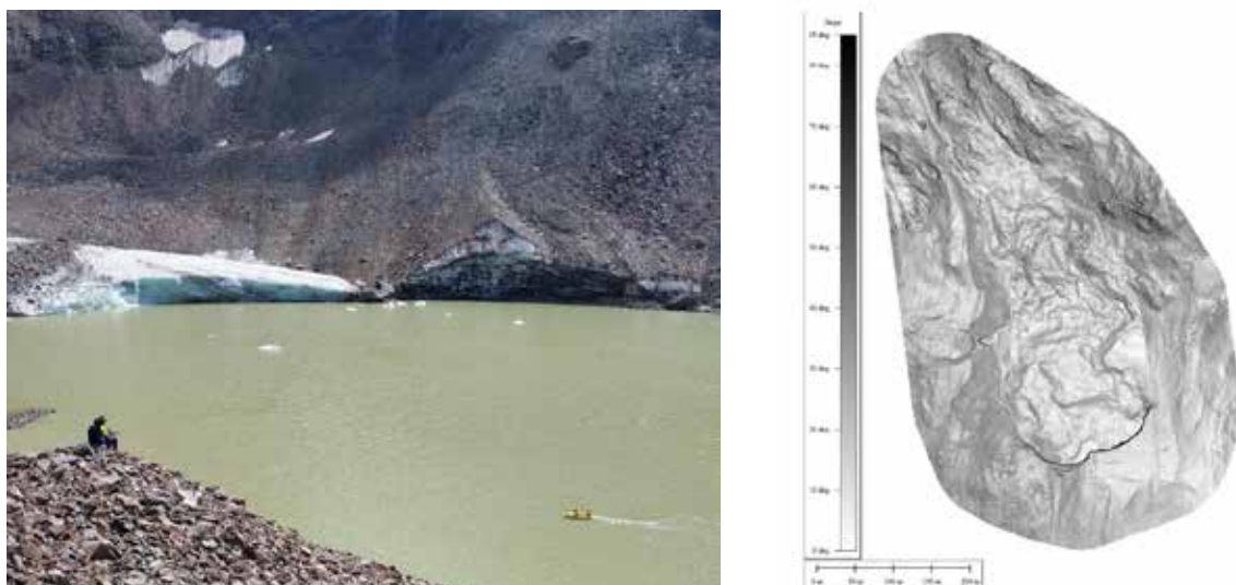
Figura 3. Misure batimetriche sul lago proglaciale della Vedretta Fredda in Valle di Riva di Tures e hillshade del DTM elaborato.
