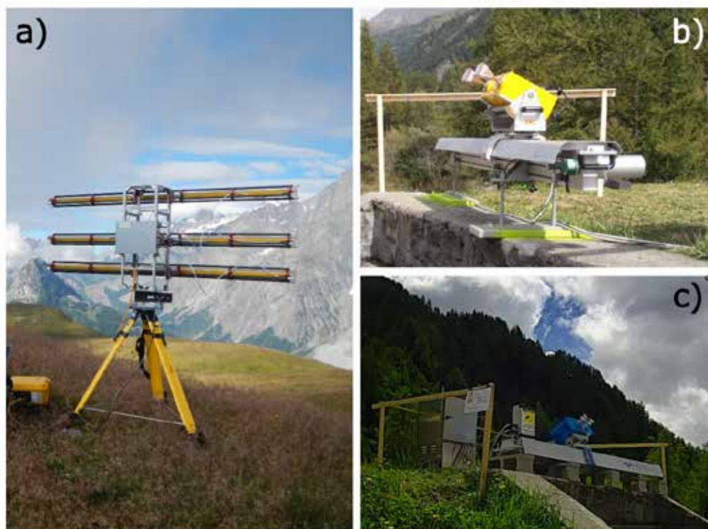
Figura 1. Modelli di radar interferometrici utilizzati durante campagne sperimentali di monitoraggio dei ghiacciai di Planpincieux e Grandes Jorasses: a) real aperture radar (RAR) modello GPRI (GAMMA remote sensing); b) ground-based synthetic aperture radar (GBSAR) modello IBIS-L (IDS Georadar); c) GBSAR modello FastGBSAR (Metasensing).
