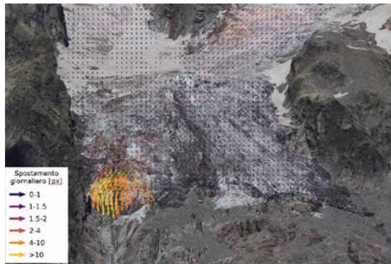
Figura 2. Esempio di mappa di spostamento giornaliero del ghiacciaio di Planpincieux ottenuta tramite procedura automatizzata di digital image correlation. Il lobo di Montitaz (sulla destra nella foto) presenta distinti settori cinematici caratterizzati da diversa velocità e andamento stagionale. Dalla porzione frontale, più attiva, si innescano frequenti crolli durante l'estate.
