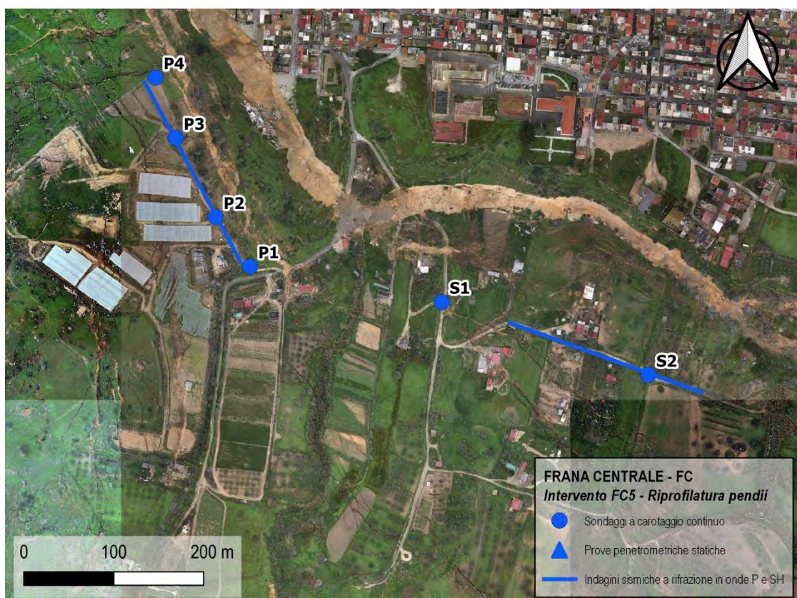
Figura 42 - Ubicazione indagini geonostiche a supporto dell'intervento FC.5.
