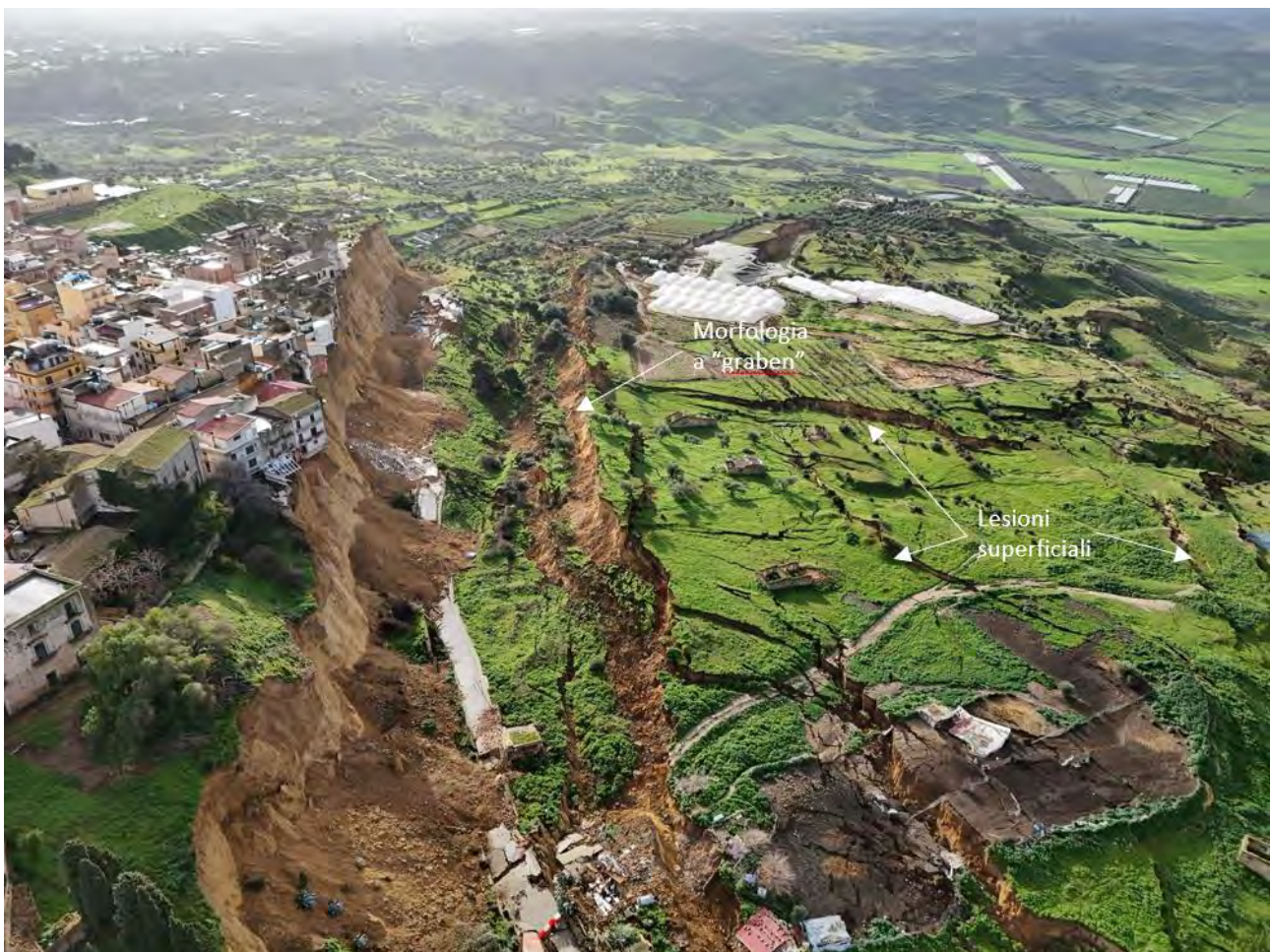
Figura 475 - Zona di valle della frana con evidenza del movimento al piede per effetto Graben e delle fratture diffuse verso valle.
