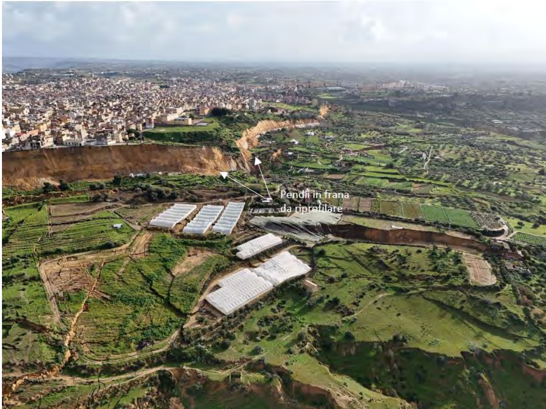
Figura 43 - Vista dei pendii in frana da riprofilare mediante eventuale impiego di terre armate.
