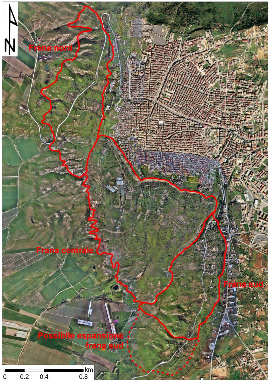
• Figura 4 - Suddivisione dell'area di frana in settori cinematicamente distinti.
