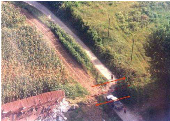
Fig. 2 – La faglia del terremoto di Izmit (Turchia) taglia e disloca una strada.
